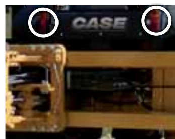
Задние дорожные фары могут устанавливаться на опорах стабилизатора при движении, а также на кабине при выемке грунта, обеспечивая максимальную видимость и защиту
